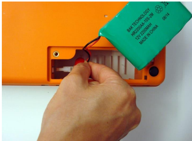
2. Odłączyć gniazdo akumulatora.
